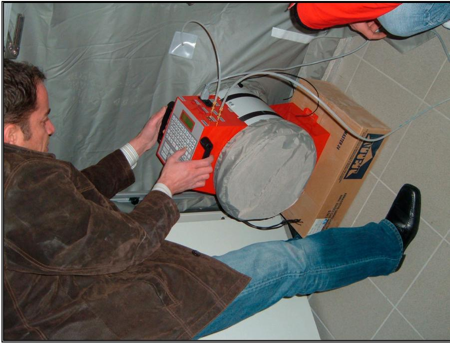
Fig. 30: „Blower-Door-Test“/
